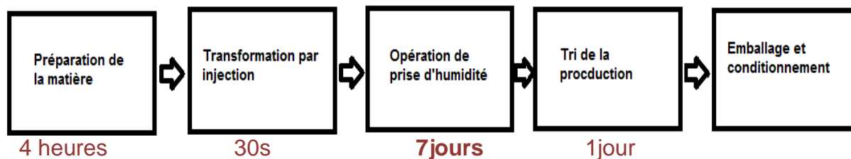
Figure 66 : Processus actuel de fabrication des colliers de serrage
