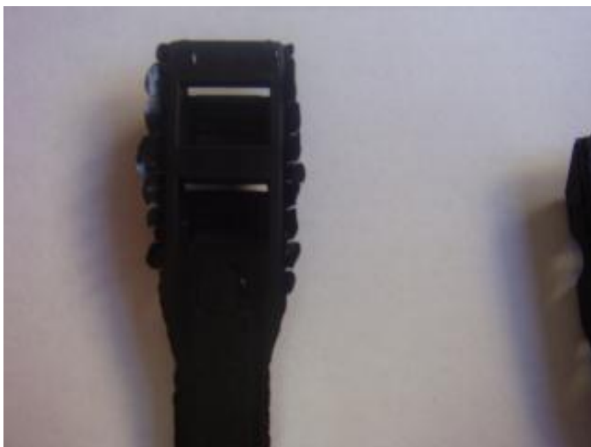
Figure 6: Bavures sur des les colliers 9x265
