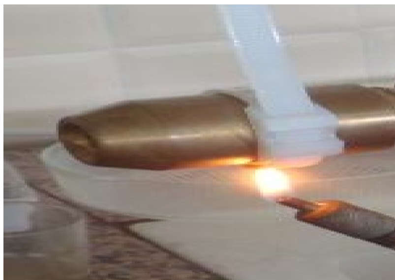
Figure 52 : Application de la flamme à un échantillon de collier de serrage (Source : Laboratoire qualité INGELEC)
