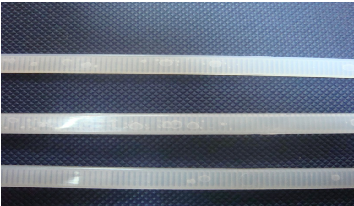
Figure 4 : Présence des bulles d'air à l'intérieur des colliers.
