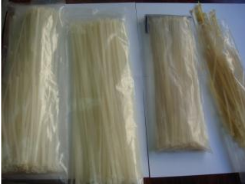
Figure 3 : Décoloration différente sur les colliers de serrage
