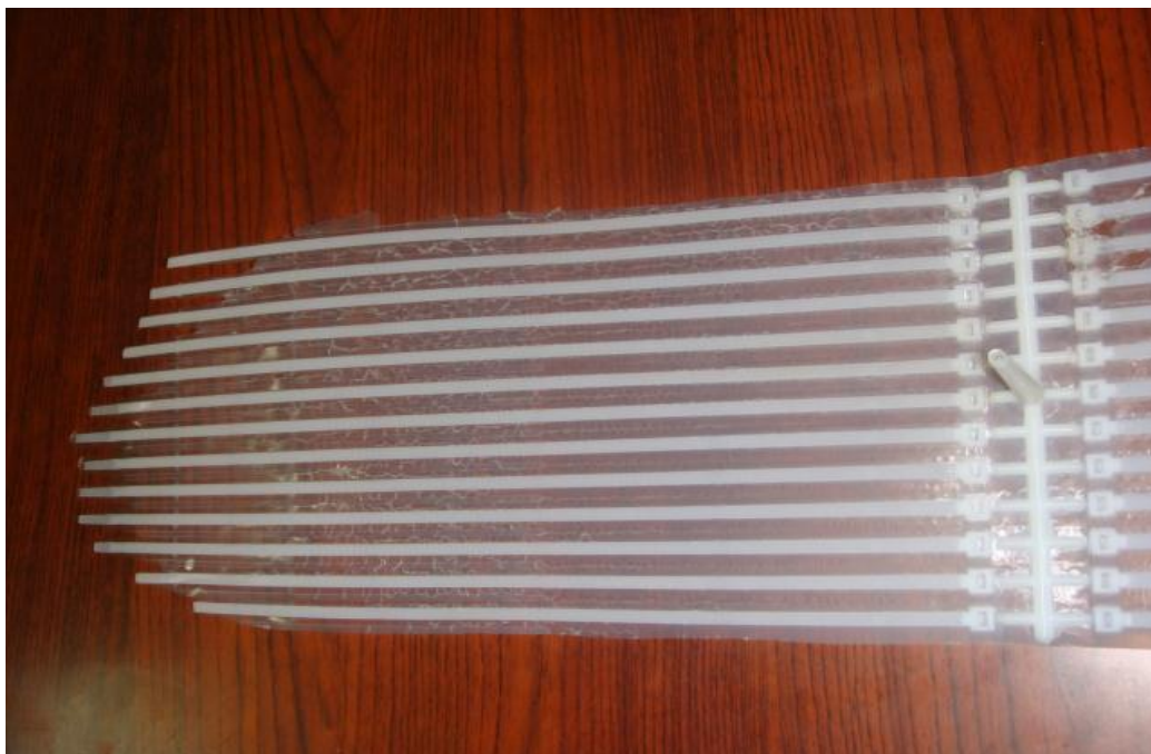
Figure 10 : Photo d'un exemple d'un moule non équilibré
