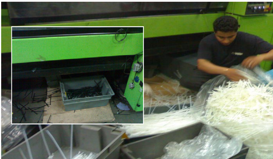
Figure 8 : L'ergonomie de la machine en cours d'injection des colliers de serrage
