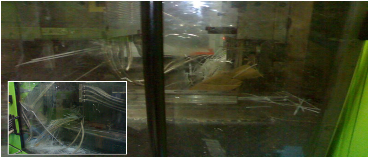
Figure 7: photo des colliers de serrage éparpillés sur le banc de la machine après éjection
