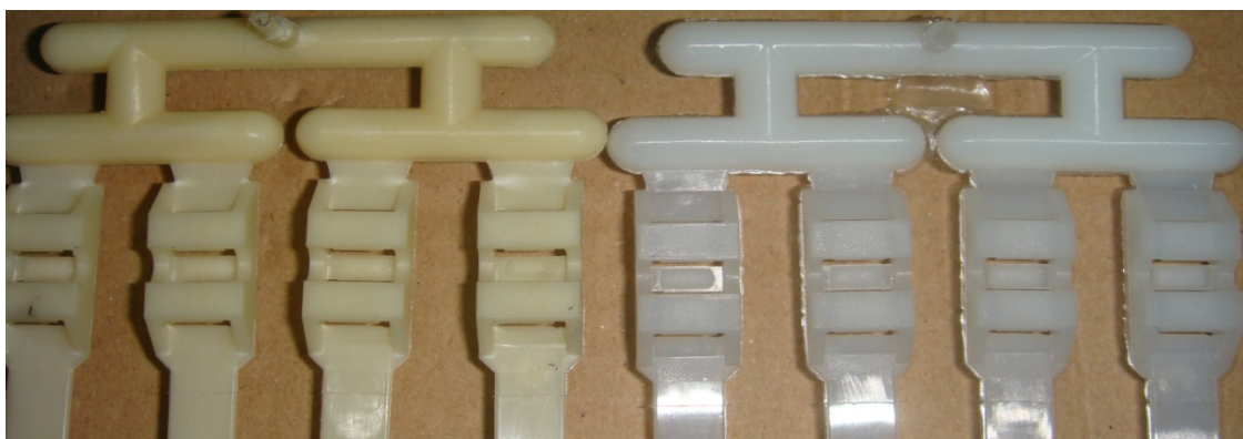
Figure 59: Comparaison entre 2 moulées à gauche PA/PP et à droite en PA66
