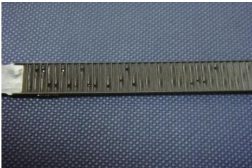
Figure 5 : Présence des retassures sur un collier 9x265
