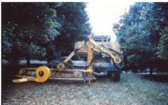
**Figure n°17: balayeuse mécanique d'après [80]**
