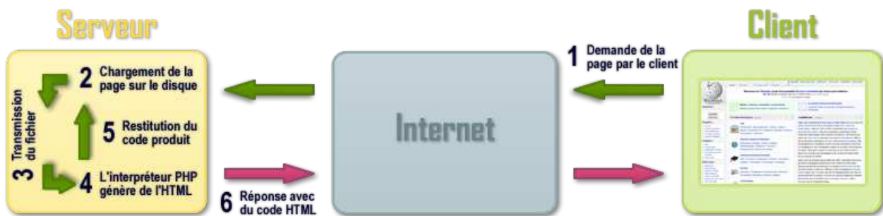
FIGURE 35 – Schéma de fonctionnement d'un script PHP. Source : [46]
