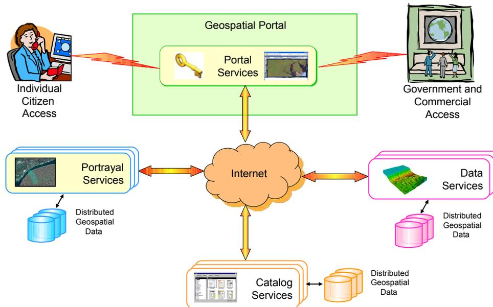
FIGURE 2.13 – Architecture d'un géoportail basé sur des services OGC
