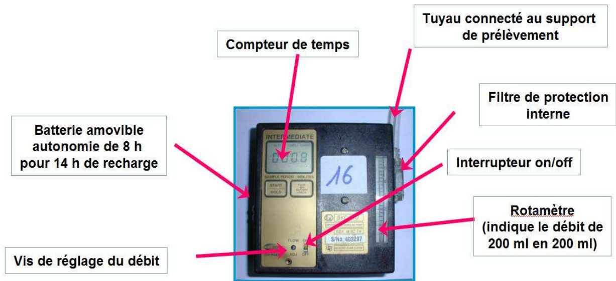
Figure 3 : Pompe individuelle : SKC Modèle 224 PCEX 4
