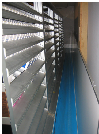
Figure 14 : Plateaux d'éjections avant (1) et arrière (2) de l'Apoteka®
