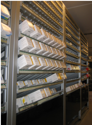
Figure 14 : Plateaux d'éjections avant (1) et arrière (2) de l'Apoteka®
