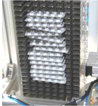
Figure 28 : ATTIS - Système de stockage des blisters à découper
