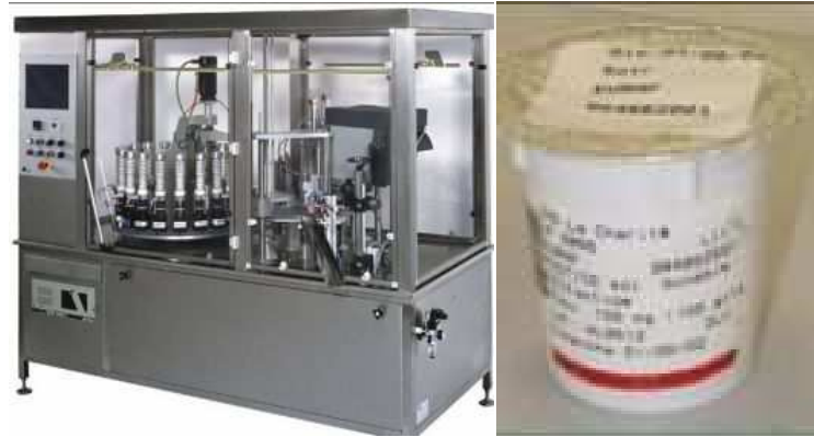
Figure 13 : Automate SyGIPH APG2 et gobelet nominatif produit (12)
