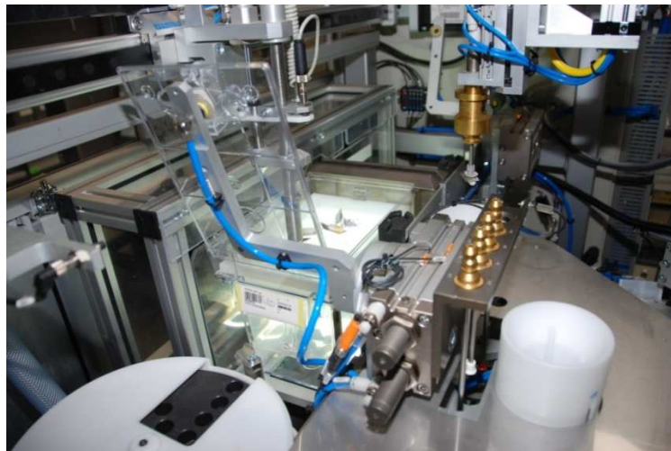
Figure 33 : CALYPSO - Chargement automatique à partir du Xydis
