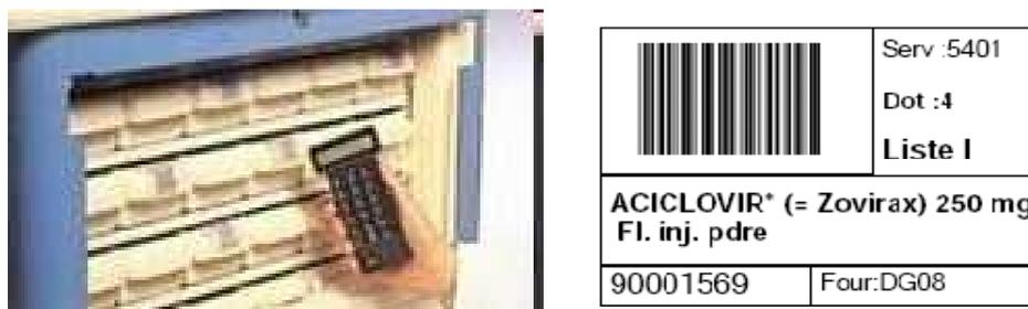
**Figure 47 : Lecteur code-barres et détail de l'étiquette de l'armoire de dotation**
