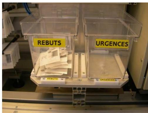
**Figure 41 : HYDRA - Bacs de déchargement “Rebut” et “Urgences”**
