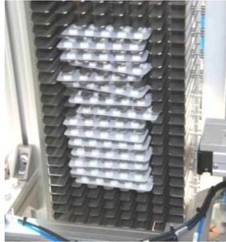
**Figure 28** : ATTIS - Système de stockage des blisters à découper
