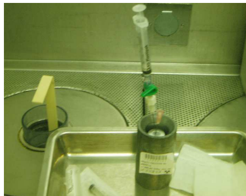
Figure 6: Solution de radionucléides dans une protection plombée
