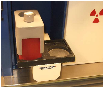
Figure 5: Générateur de Technétium dans une enceinte blindée
