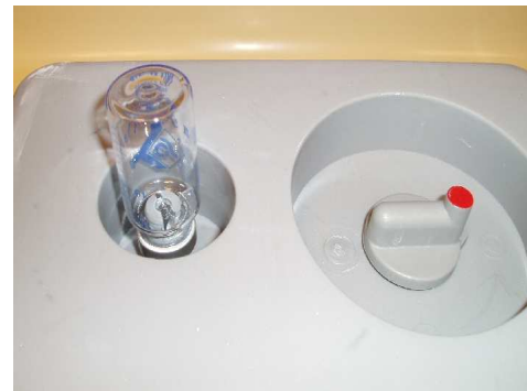
Figure 4: Emplacement du flacon sous vide lors de l'élution
