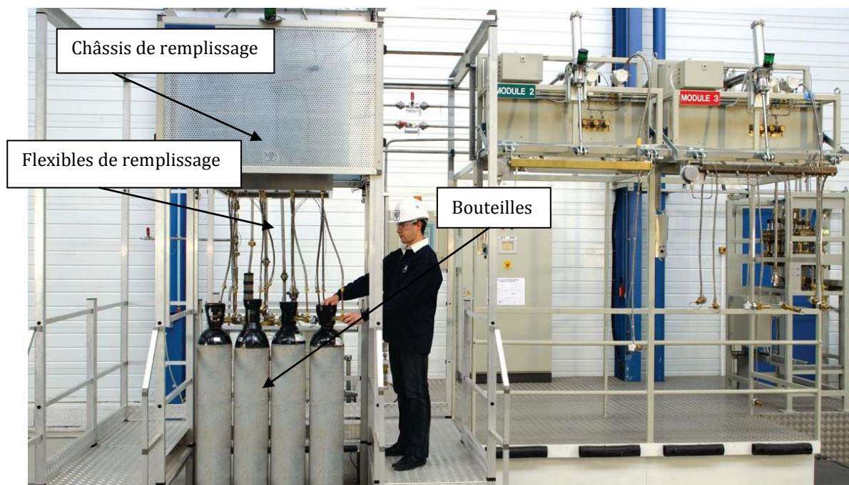
Figure 10: photo d'une rampe de remplissage Cryostar®
