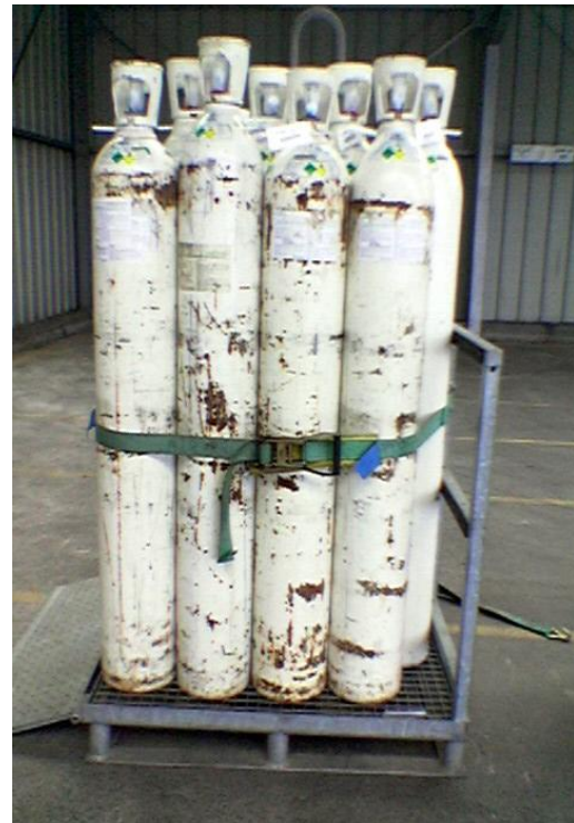
Figure 4: Bouteilles détériorées stockées à l'extérieur
