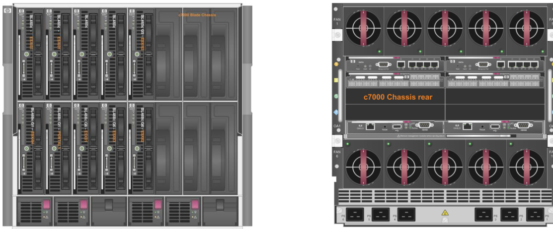
Figure 25 - Châssis HP C7000 Provost : vue avant et arrière
