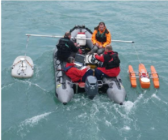
*Fig 1.a : Déploiement mobile de deux ADCP*
