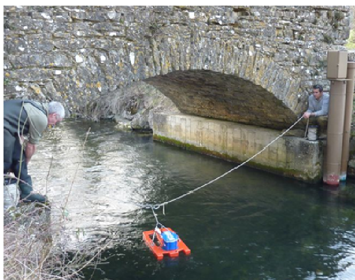
Fig. 20 & 21: Déploiement d'un ADV Flowtracker sur perche et d'un ADCP SP2400 kHz sur le Durzon à Nant.
