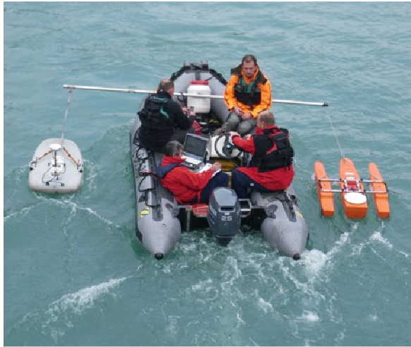
Fig 1.a : Déploiement mobile de deux ADCP
