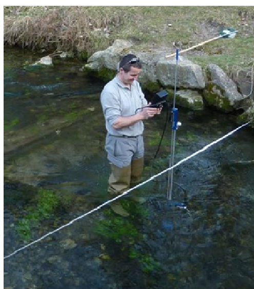
Fig. 20 & 21: Déploiement d'un ADV Flowtracker sur perche et d'un ADCP SP2400 kHz sur le Durzon à Nant.
