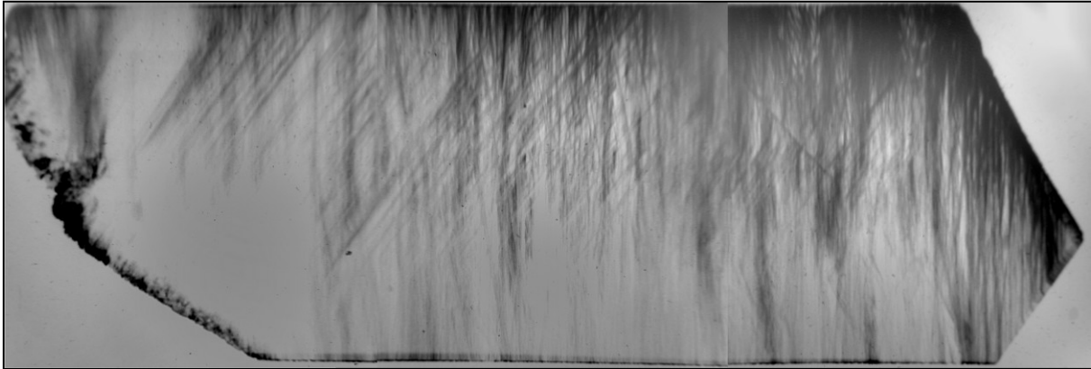
Figure 6. Image obtenue par topographie aux rayons X en laboratoire. Effectué sur un échantillon de GaPO 4 , les lignes noires observées représentent le champ de contrainte associé aux dislocations induites au cours de la croissance
