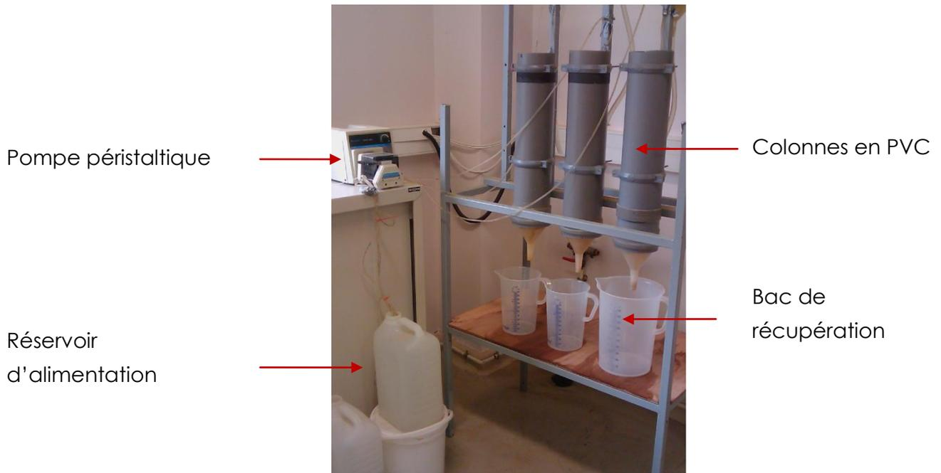
Figure 3.7: Photo du banc d'essais réalisé en fonctionnement
