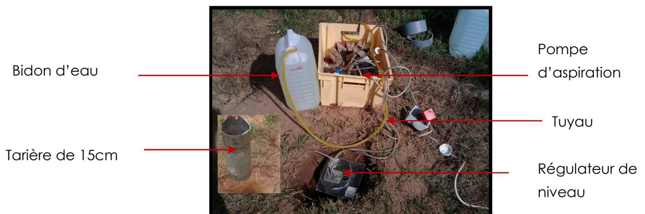
Figure 3.5 : Photo de dispositif de test de Porchet
