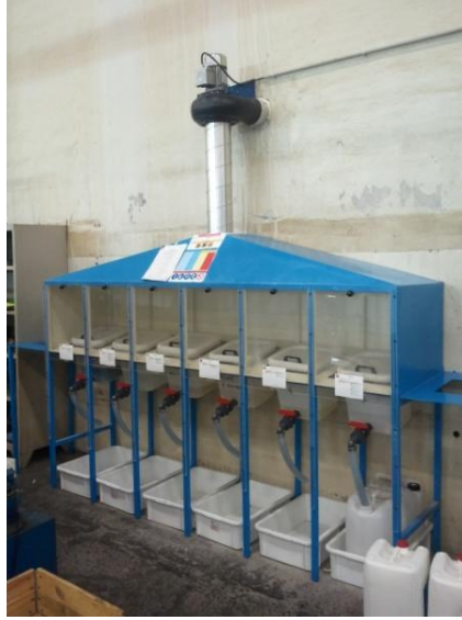
Figure 25 : Photo du poste de travail « Bain Nital »
