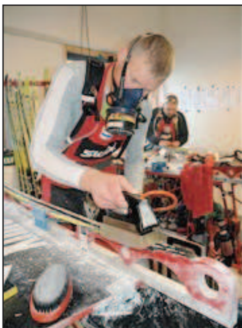
Figure 7 : Technicien farteur disposant d'un masque de protection avec filtre.
