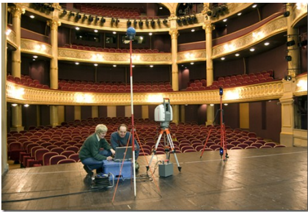
Figure 46 Campagne de relevé laser
