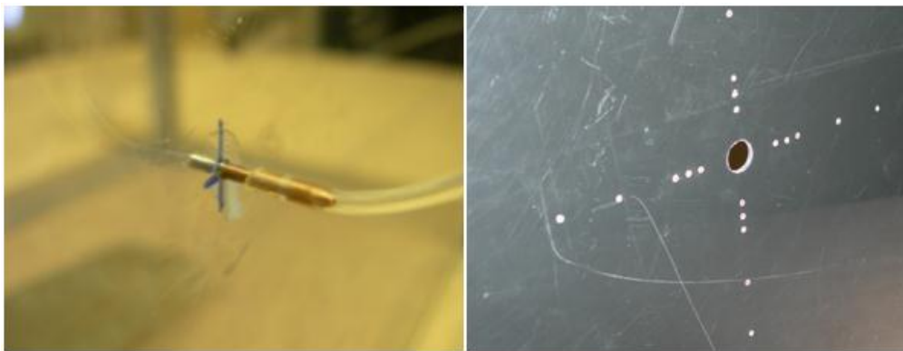
Figure II-19 : photo du tube de cuivre avec le vinyle connecté et photo des tubes vinyles affleurant sur la plaque d'un orifice ( d = 1 cm)
