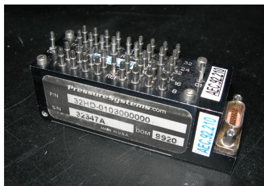
Figure II-18 : Capteurs de pression PSI de 32 voies à une fréquence d'acquisition de 200 Hz
