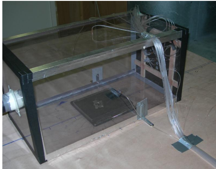
Figure II-15 : photo du caisson fixé à 0^\circ avec les prises de pressions connectées
