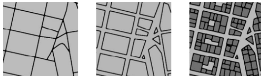
FIGURE 10 – Exemple de division du plan de route en blocs puis en parcelles pour les bâtiments, dans l'article sur CityEngine de Müller et Parish[6].
