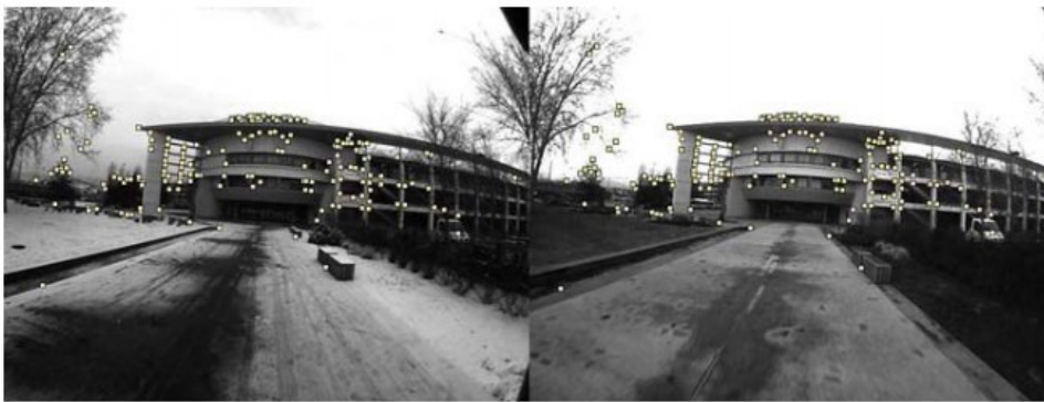
FIGURE 3.1 – Figure tirée de [20]. A droite les points détectés dans l'image courante sont mis en correspondance avec ceux de l'image référence à gauche afin de calculer la pose de la caméra dans le monde 3D.
