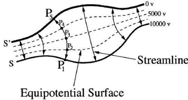
FIGURE 3.7 – Exemple 2D de l'équation de Laplace résolue entre  $S$  et  $S'$ . Les valeurs de potentiels de 0V et 10000V sont des conditions aux frontières pour résoudre l'équation. Le chemin connectant  $P_1$  à  $P_5$  montre l'épaisseur corticale calculée.
