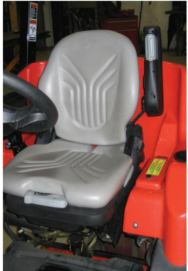
Figure VI.7 et VI.8 : Photos de la tondeuse Jacobssen. On retrouve les lames hélicoïdales. A noter la présence d'un siège suspendu, réglable au niveau du poids.
