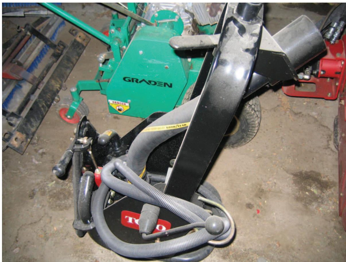
Fig I.12 : pompe à eau des bunkers.
