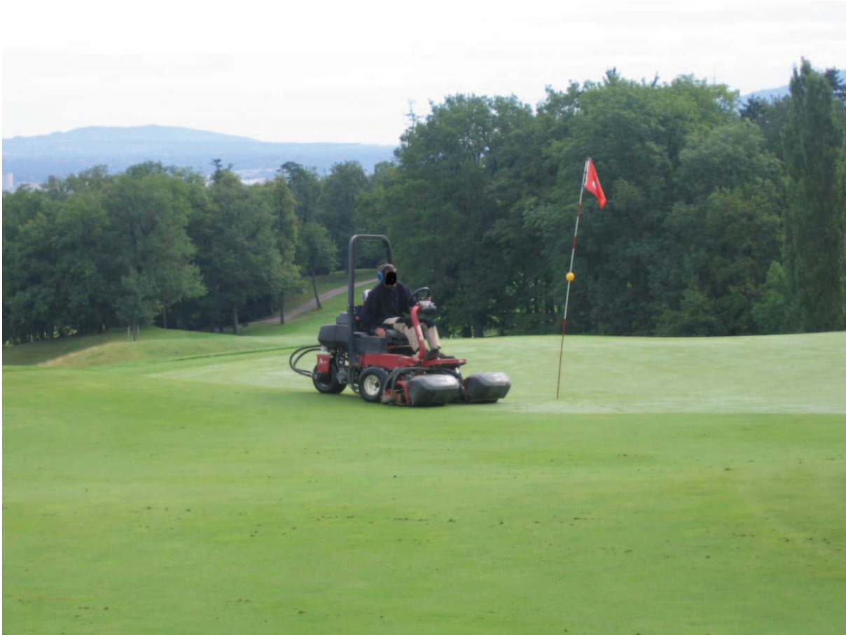
Fig I.2 : machine à green en fonctionnement sur le green. Les lames sont abaissées lorsque le paysagiste est en train de tondre.
