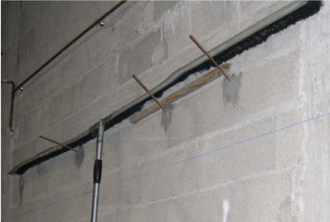
Fig I.8 : balai en aluminium utilisé pour le balayage de la rosée. Il pèse environ 5 kg. Il possède un long manche et une grande envergure.
