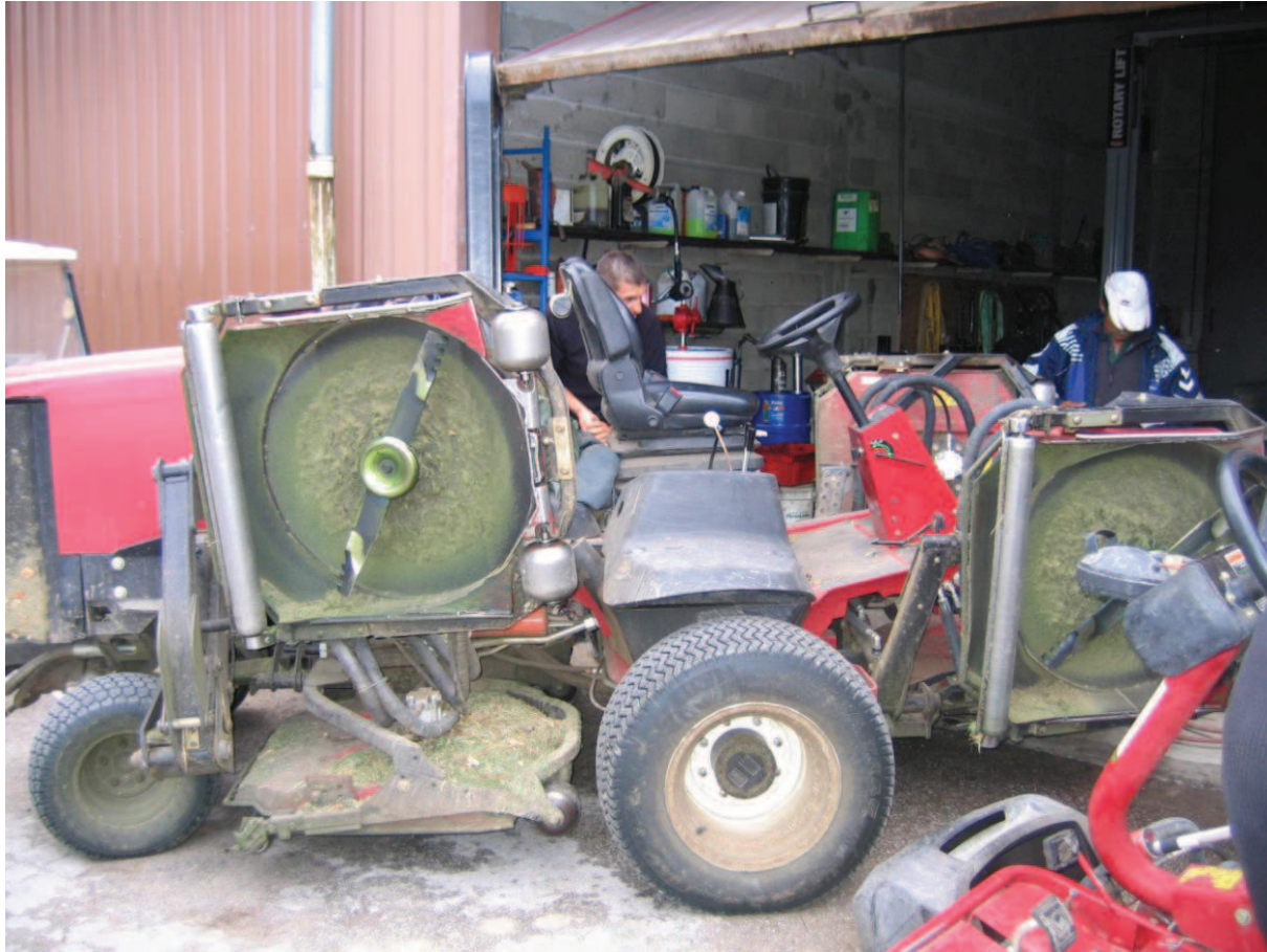
Fig 4 : machine à tondre les roughs. Les lames sont abaissées lors de la tonte. Les lames sont ici vues de dessous.
