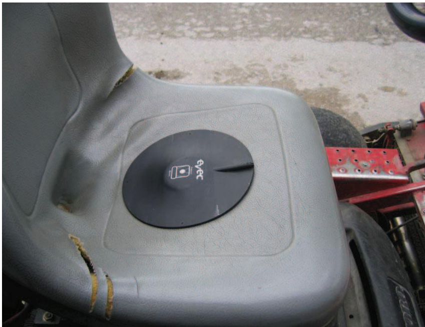
Figure V.1 : capteur EVEC installé sur le siège d'une machine à green.
