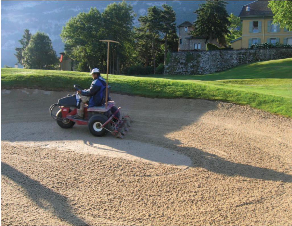
Fig I.9 : Machine à bunker. A noter l'absence de suspension au niveau du siège, seuls les pneus sont amortisseurs. Pas de possibilité d'adapter un siège suspendu.
