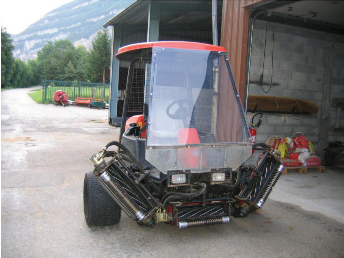
Fig 1.3 : machine à tonte de fairway. Présence de 3 lames hélicoïdales. Les lames sont abaissées lors de la tonte des fairways.
