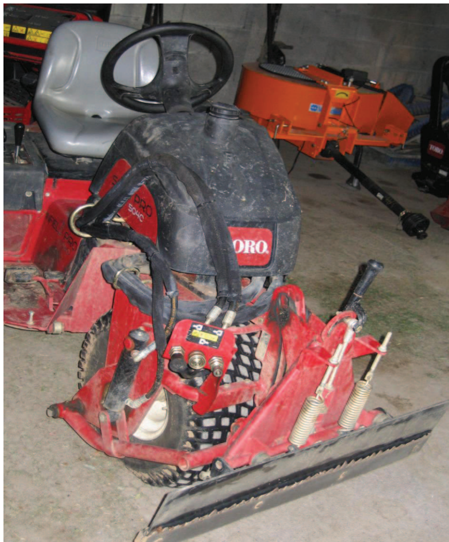
Fig I.11 : machine pour remonter le sable du bunker grâce à sa lame située à l'avant.
