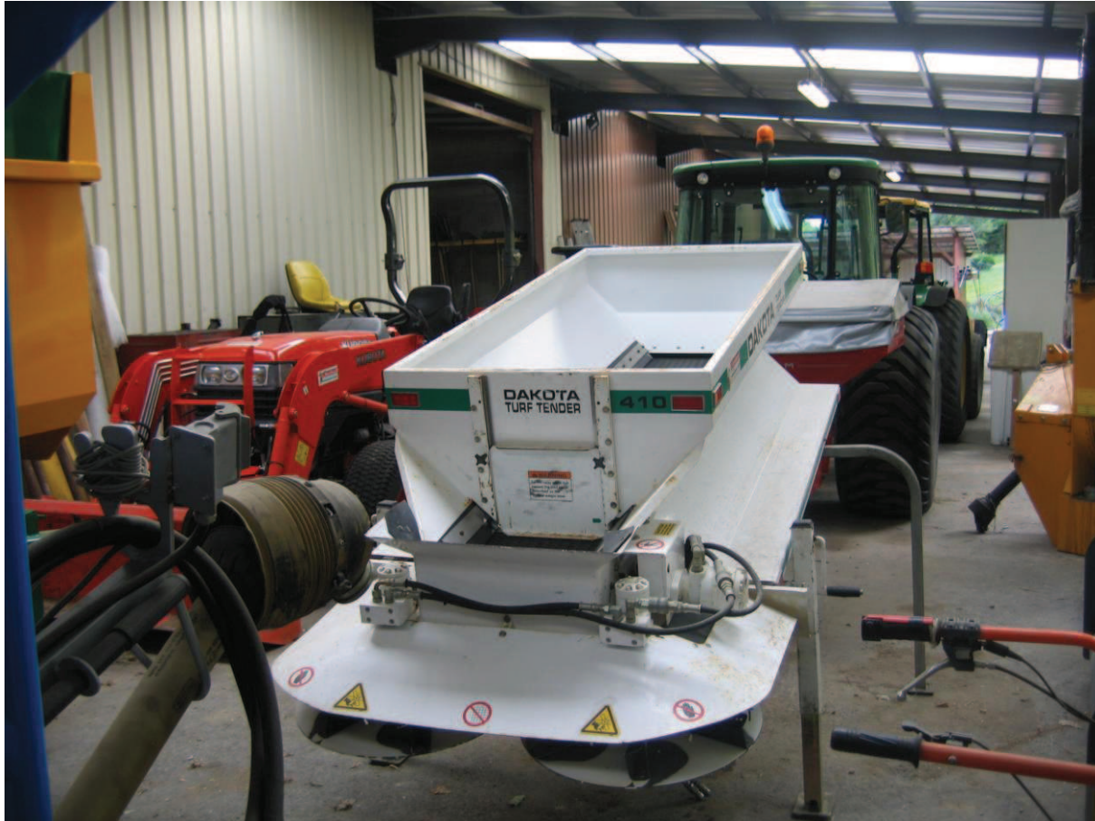
Fig I.6 : le sableuse : un tapis roulant vient déposer le sable sur le green. Des commandes hydrauliques permettent de régler la vitesse de délivrance du sable.
