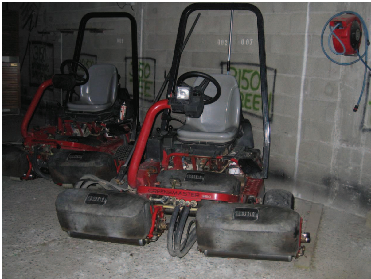
Fig I.1 : machines à tonte de green. Pas de siège suspendu. Commandes sur le coté. Lames hélicoïdales.
