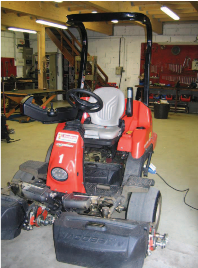
Figure VI.7 et VI.8 : Photos de la tondeuse Jacobssen. On retrouve les lames hélicoïdales. A noter la présence d'un siège suspendu, réglable au niveau du poids.
