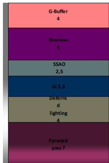
FIGURE 14 – Schéma donnant l'ensemble du pipeline dans le CryTek engine 3. On remarque que l'illumination globale doit être calculée en seulement 3.3 ms.
