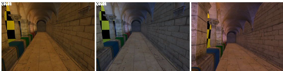
(a) Résultat sans balance des blancs (b) Résultat après l'application de la méthode Grey world sous CPU (c) Résultat après l'application de la méthode Grey world sous GPU
