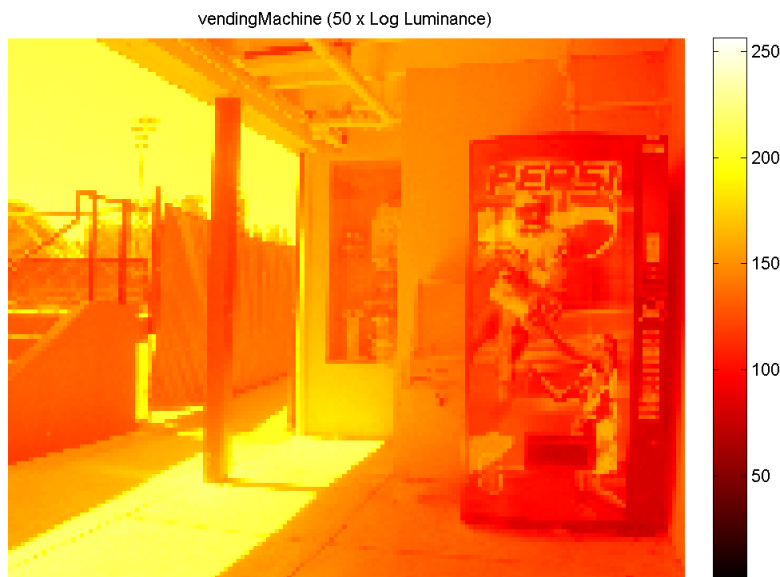
FIGURE 6 – Exemple d’une scène réelle prise avec un appareil photographique pouvant produire directement des images HDR. Les valeurs de luminance affichées varient de 1 à 10^5 cd/m^2
