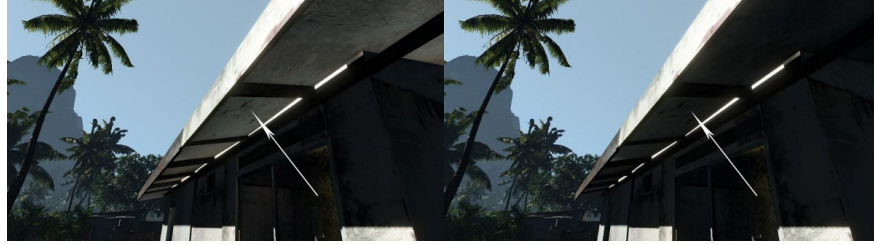
FIGURE 18 – Gauche : Utilisation d'un filtrage trilineaire. Le problème vient du fait que le toit est plus fin que la taille d'une cellule du LPV. Donc lors de l'interpolation, on prend en compte l'éclairage sur le dessus du toit ce qui produit du faux éclairage. Droite : CryTek propose une technique d'interpolation permettant de contrer ce problème. Pour ce faire, ils déplacent virtuellement l'éclairage dans la direction opposée au gradient par rapport à la normale du point.
