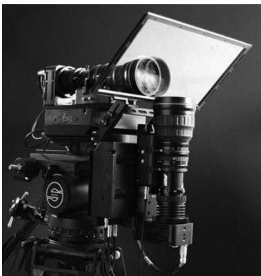
Figure 1.4. Plate-forme de caméras 3D avec miroir semi transparent Figure 1.5. Plate-forme de caméras 3D parallèle
