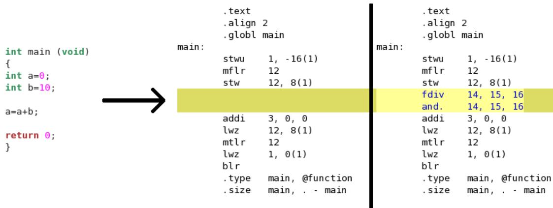
FIG. 4.2 – Exemple d’insertion de code mort
