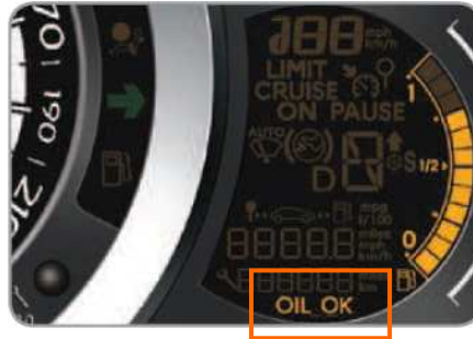
Figure 17 : Affichage de l'indicateur de niveau d'huile sur un combiné C3.
