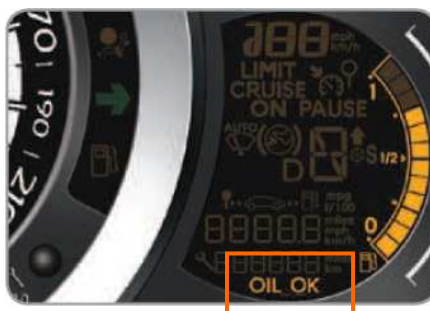
Figure 17 : Affichage de l'indicateur de niveau d'huile sur un combiné C3.
