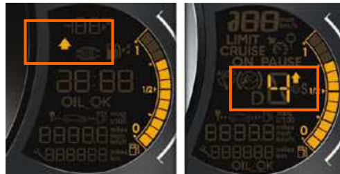
Figure 16 : Affichage du Gear Shift Indicator sur un combiné C3 et un combiné DS3.
