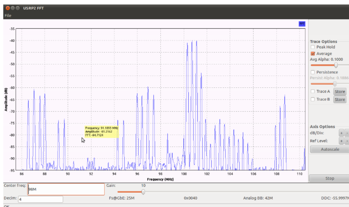
Figure 43 : Diagramme FFT ( usrp2_fft ) de la bande FM
