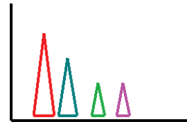
Gradient de solvant Bonne séparation et temps d'analyse raisonnable
