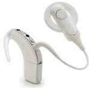
**Figure 5: Partie externe d'un implant sans boîtier ; Marque Cochlear ®**
