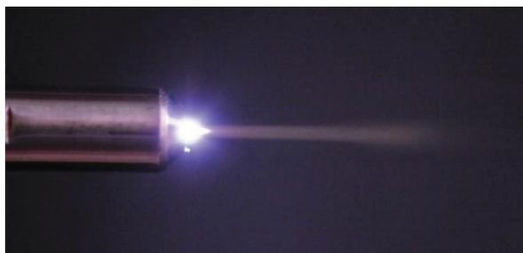
Le plasma ainsi créé est électriquement neutre (le nombre d'ions positifs est égal au nombre d'électrons négatifs). Aucun courant électrique ne passe dans le patient. Cette situation contraste avec l'électrochirurgie classique ou bistouri électrique monopolaire/bipolaire pour laquelle un courant de haute fréquence (jusqu'à 9000 Volts) est utilisé et traverse le patient, évitant ainsi certains accidents à savoir les brûlures thermiques et électriques.
