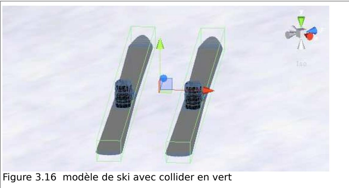
Figure 3.16 modèle de ski avec collider en vert
