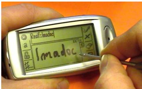
Figure 0-2 Interface de composition orientée stylo [4]
