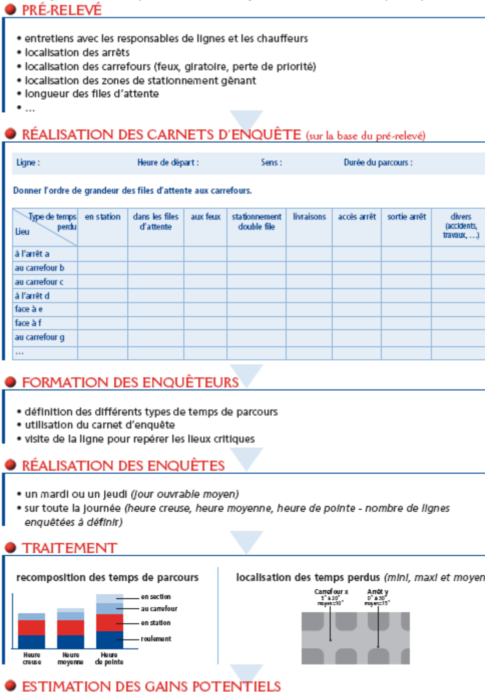
Figure 22 : Exemple de méthodologie de mesure des temps de parcours
