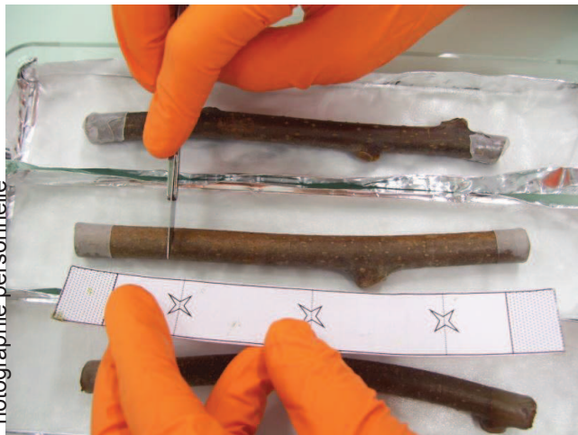
Figure 25 : Des incisions de 2 mm de profondeur sont réalisées au scalpel, perpendiculairement au rameau. Chaque rameau est blessé en 3 points distants l'un de l'autre de 4 cm, dont la position sur le rameau est repérée à l'aide d'une réglette cartonnée.
