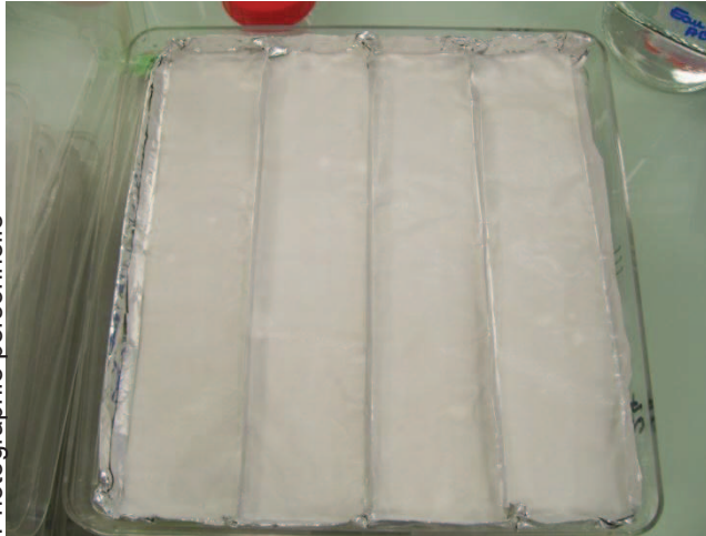
Figure 24 : Boîte en plastique rigide (23 x 23 cm) dans laquelle sont disposées verticalement 4 barquettes en aluminium (22 x 5,5 cm), chacune tapissées d'une bande de papier-filtre humectée par 3 ml d'eau déminéralisée stérile.
