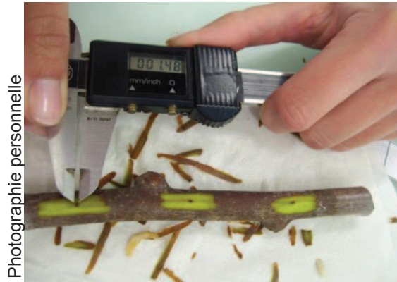
Figure 29 : La nécrose est mesurée manuellement à l'aide d'un pied-à-coulisse électronique, après suppression de l'écorce au scalpel sur une longueur d'environ 1,5 cm de part et d'autre de chaque blessure réalisée.
