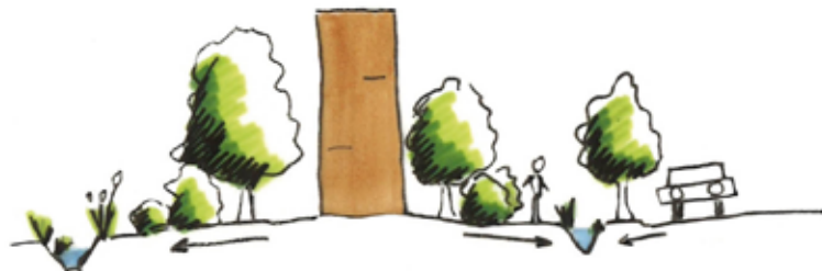
Figure 1 : Noues recueillant les écoulements d'eau, dans la rue et dans la parcelle.
