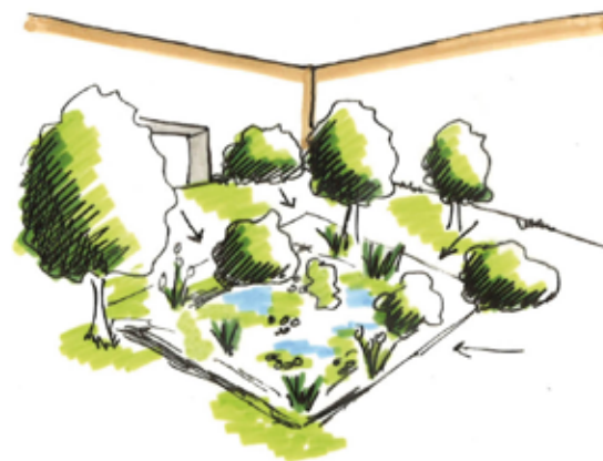
Figure 2 : Bassin de rétention paysager en cœur d'îlot.
