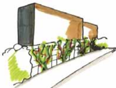
e. Clôture utilisée comme base de végétalisation.
