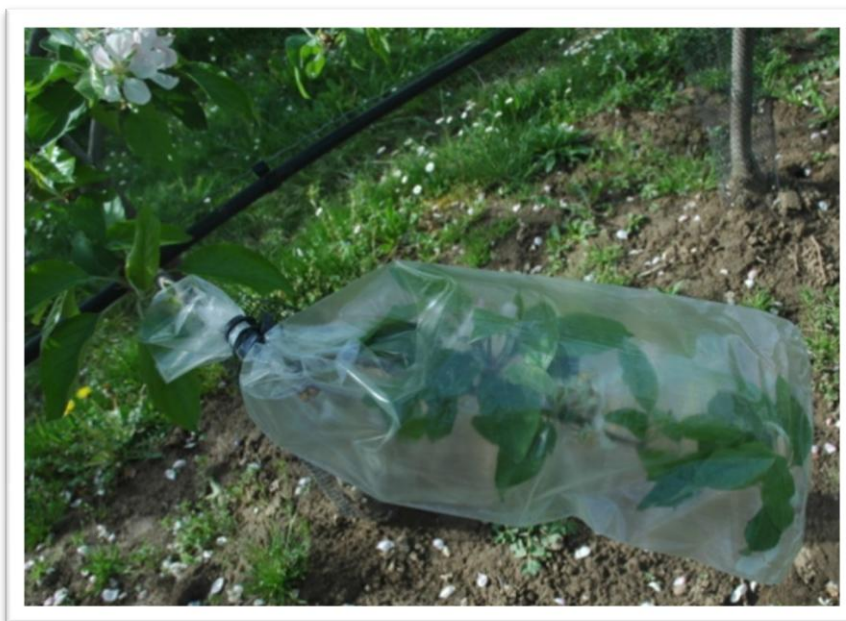
Figure 30 : Photographie (A.Marceron) d'un pochon à éthylène utilisé au départ pour capturer les émissions d'éthylène
