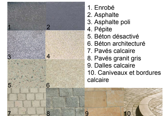
Figure 66 : Exemples de revêtements proposés dans les zones de circulations particulières dans les projets de Bourgoin-Jallieu et Annemasse - Source : Folia 2011 et 2012
