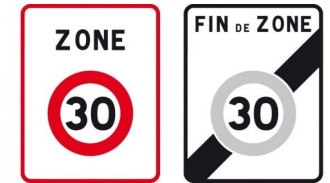
Figure 25 : Panneaux réglementaires entrée/sortie d'une zone 30 - Sources : [14] & [15]
