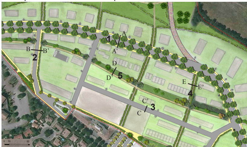
Figure 29 : Les axes de communication et traits de coupes, Quartier de l'Orée du bois, P.Stanislas, 2012.
