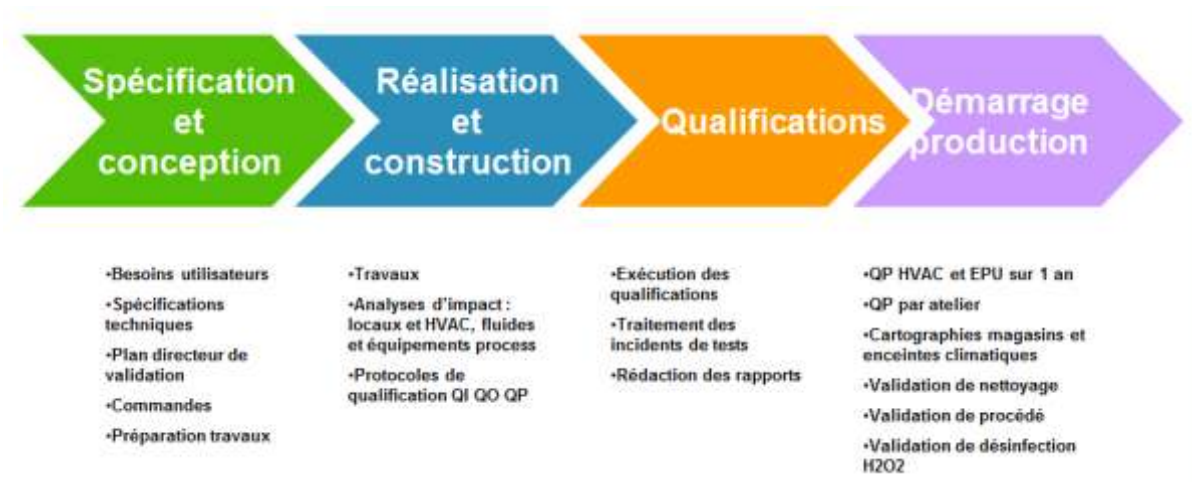
Figure n°11 : Les différentes phases du projet revamping
