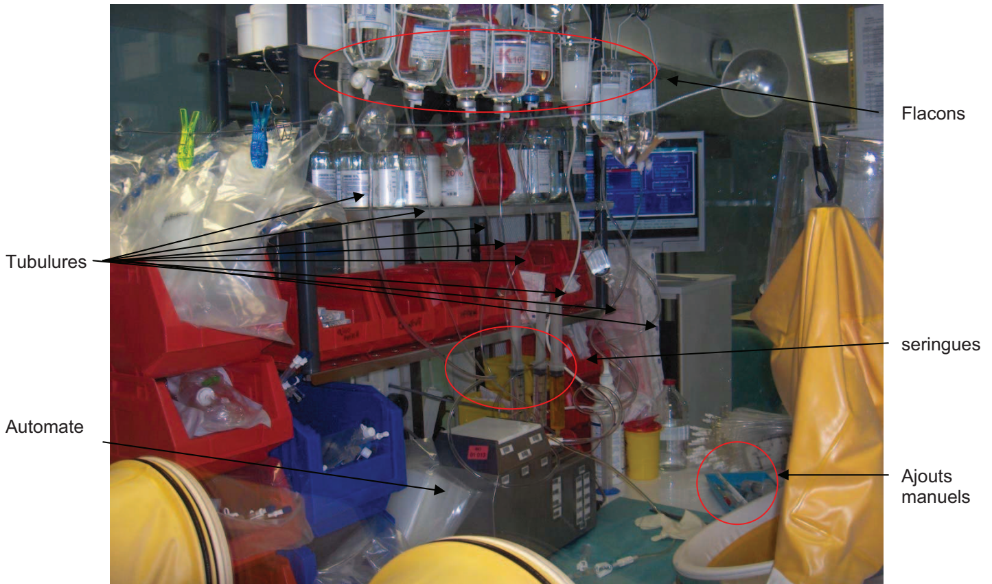
Figure 8 : Automate de fabrication des poches de nutrition parentérale pédiatrique BAXA.
