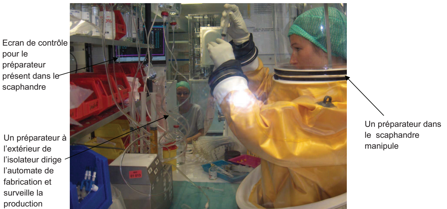
Figure 9 : Manipulation de l'automate de fabrication BAXA.
