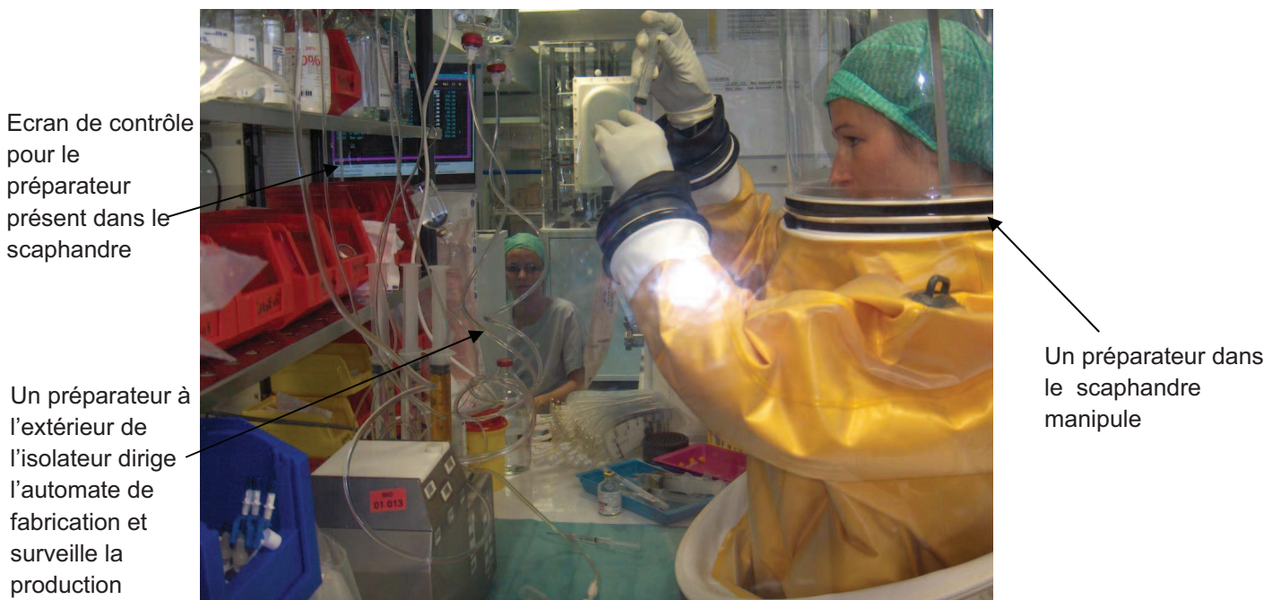
Figure 9 : Manipulation de l'automate de fabrication BAXA.
