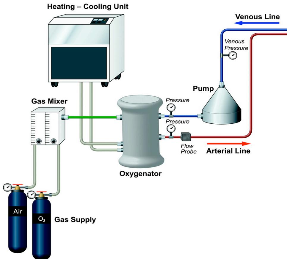
Figure 4 : composition du circuit d'une ECLS artério veineuse
