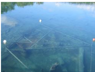
4.3 Vue du système de triangulation sous l'eau
