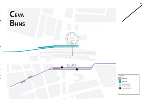
Figure 39. Schéma de circulation dans le PE pour le CEVA et le BHNS. Source : In Situ, 2012
